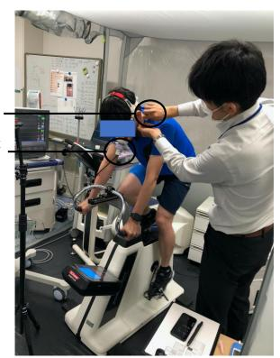
血中乳酸測定 Lactate PRO 呼気ガス分析装置 AE301S
